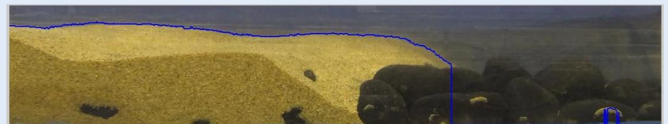
Experimento en un canal de laboratorio. Material fino irrumpiendo en un lecho de grava. El flujo es de izquierda a derecha.
